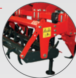
Regolazione manuale rulli posteriori Regulación manual de los rodillos traseros
